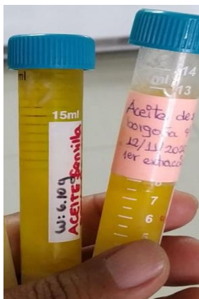
Figura 5.-Extracción de aceite de semilla con \text{CO}_2 supercritico
