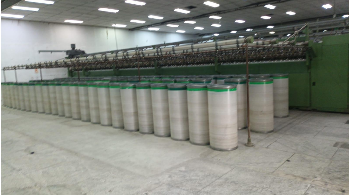
PLANTA PRODUCTIVA - AREA DE MECHERAS
